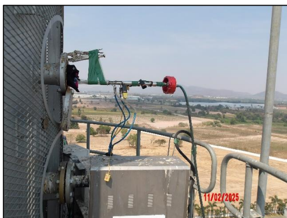
รูปที่ 3.2 การเก็บตัวอย่างคุณภาพอากาศในปล่องระบาย บริเวณปล่องระบายหน่วยผลิตไอน้ำ HRSG 12
