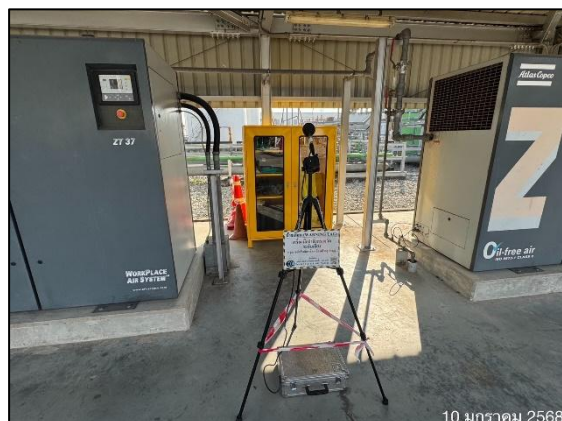
รูปที่ 3.9 การตรวจวัดระดับเสียงในพื้นที่ทำงาน บริเวณเครื่องอัดอากาศ
